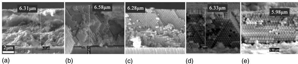
FIG. 4. Film thickness measured by SEM: (a)  $R=85$  nm,  $h=6.31$   $\mu\text{m}$ ; (b)  $R=110$  nm,  $h=6.58$   $\mu\text{m}$ ; (c)  $R=150$  nm,  $h=6.28$   $\mu\text{m}$ ; (d)  $R=180$  nm,  $h=6.33$   $\mu\text{m}$ ; (e)  $R=210$  nm,  $h=5.98$   $\mu\text{m}$ .
